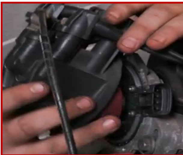
Fig.12.3 Capacul distribuitor al aprinderii electronice
