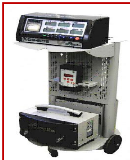
Fig.9.3 Analizor de 4 gaze la motoarele pe benzină + opacimetru pentru motoarele Diesel
