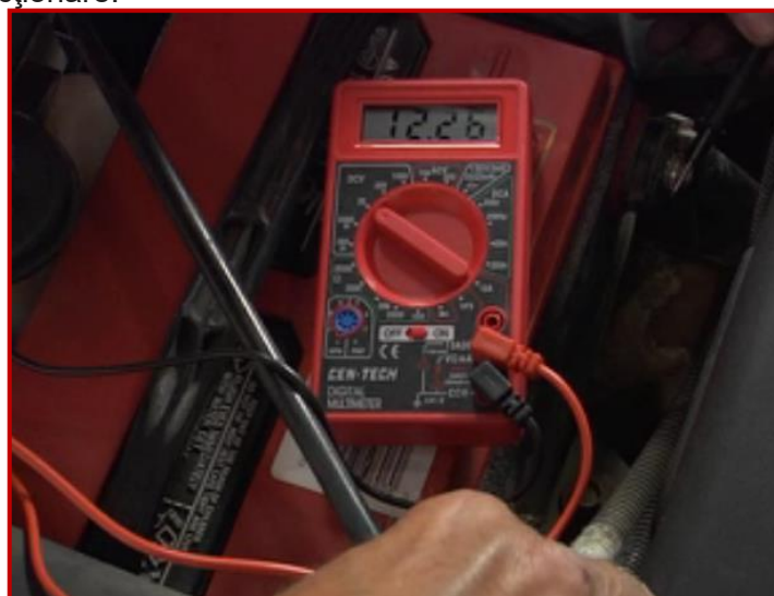
Fig.10.5 Măsurarea tensiunii bateriei
