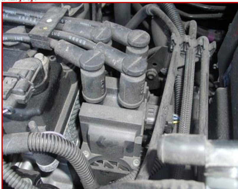
Fig. 12.1 Sistemul de aprindere al autovehiculului FORD B-Max
