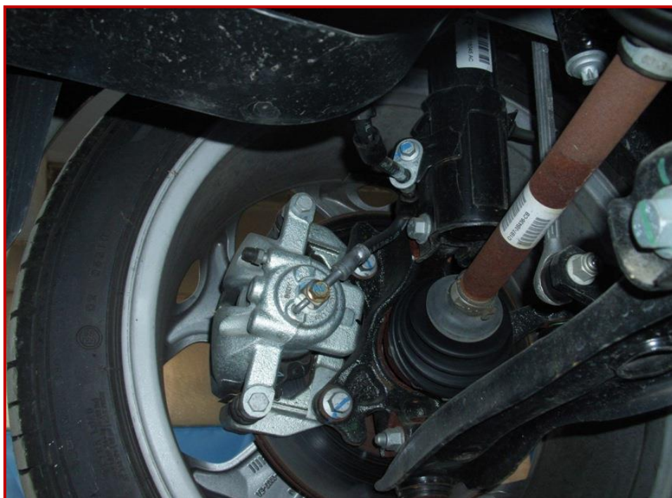
Fig.16.1 Frâna cu disc din față a autovehiculului FORD B-Max
