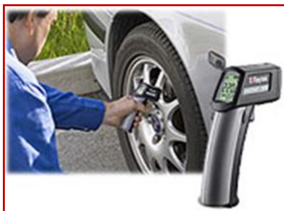
Fig.19.3 Măsurarea temperaturii pneului
