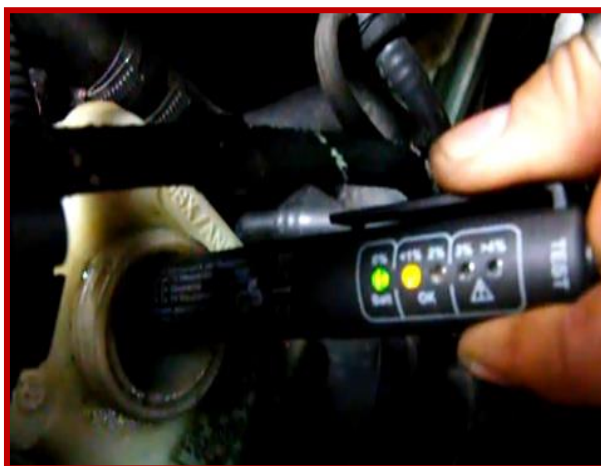
Fig. 16.4 Verificarea calității lichidului din rezervorul pompei centrale
