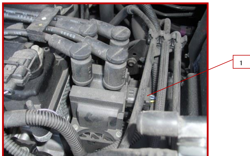
Fig.12.8 Conectorul principal al bobinei de inducție a autovehiculului FORD B-Max
