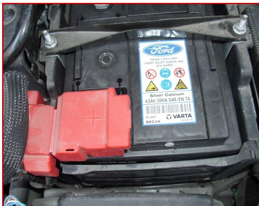
Fig. 10.1 Bateria de acumuloare a autovehiculului FORD B-Max
