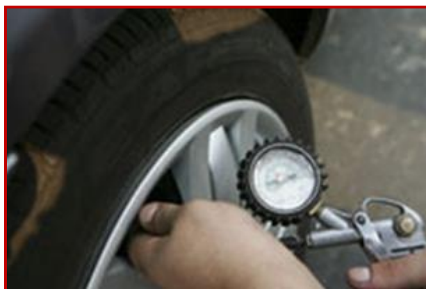
Fig.19.2 Verificarea cu manometrul
