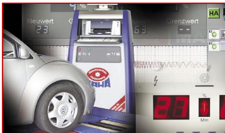
Fig.18.3 Testarea amortizoarelor fără demontarea lor
