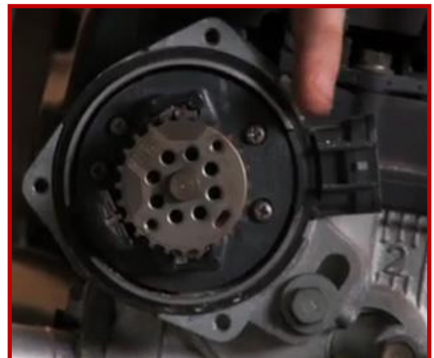
Fig.12.4 Armătura și bobina de preluare (pickup)
