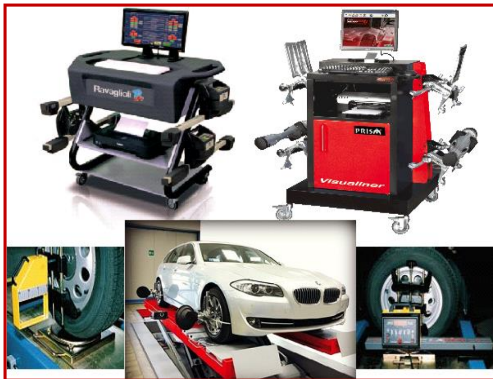
Fig.15.5 Echipamente pentru verificarea și reglarea geometriei direcției
