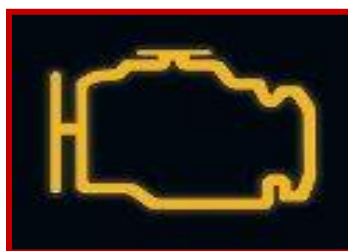
Fig. 5.2. Indicatorul MIL (Malfunction Indicator Lamp) denumit și „Check Engine” lampă indicatoare a defecțiunilor
